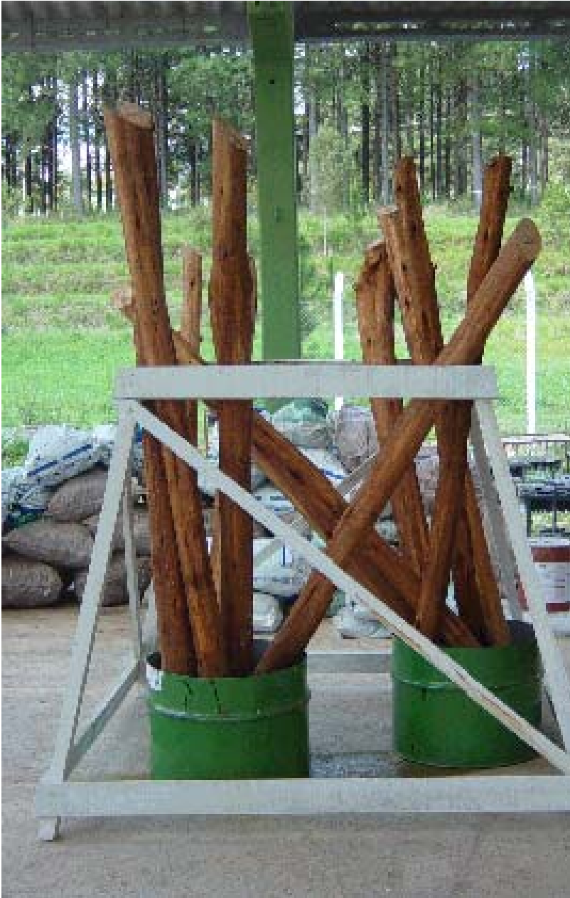
Figura 9. Mourões em tratamento pelo processo de Substituição de Seiva.
